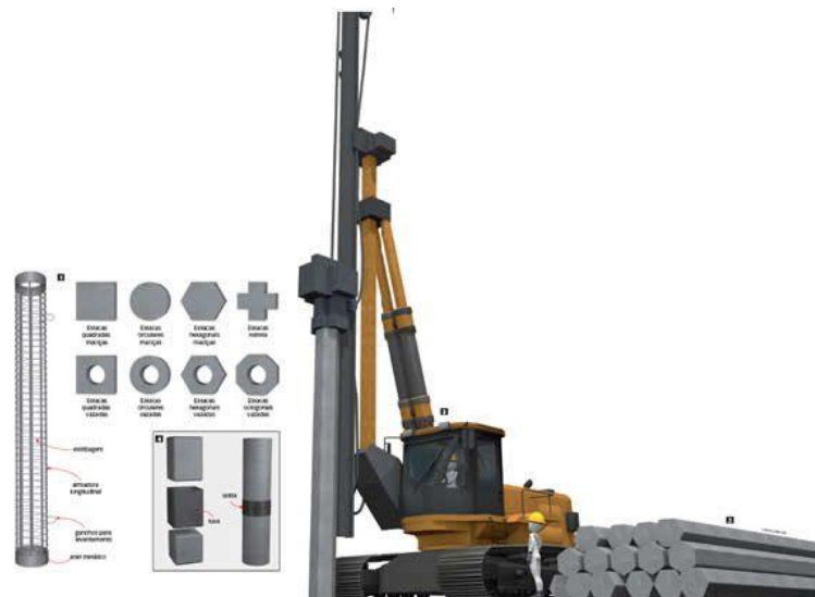
Figura 24: Estaca pré-fabricada de concreto - diferentes seções
