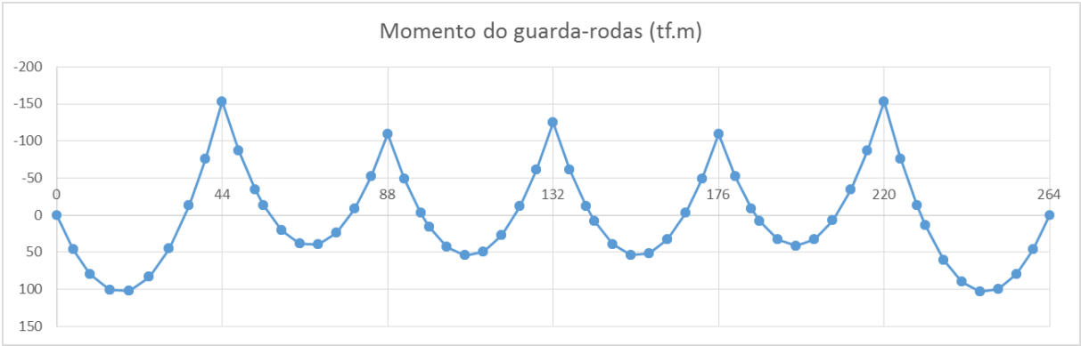
Figura 64: Diagrama do momento fletor devido ao guarda-rodas
